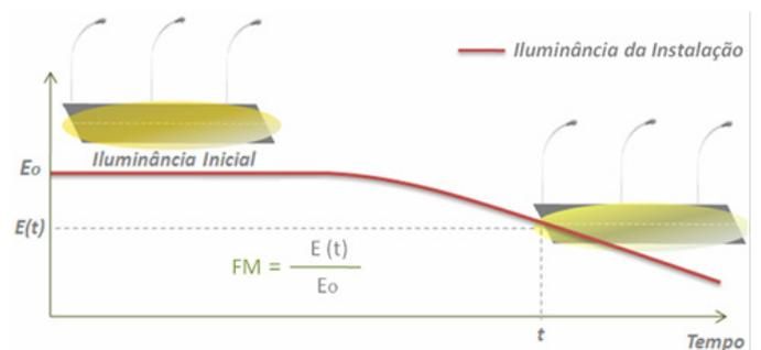
O valor do fator de manutenção poderá afetar significativamente a potência da fonte de luz a instalar, bem como o número de luminárias necessárias para alcançar os valores de iluminância/iluminância especificados.
